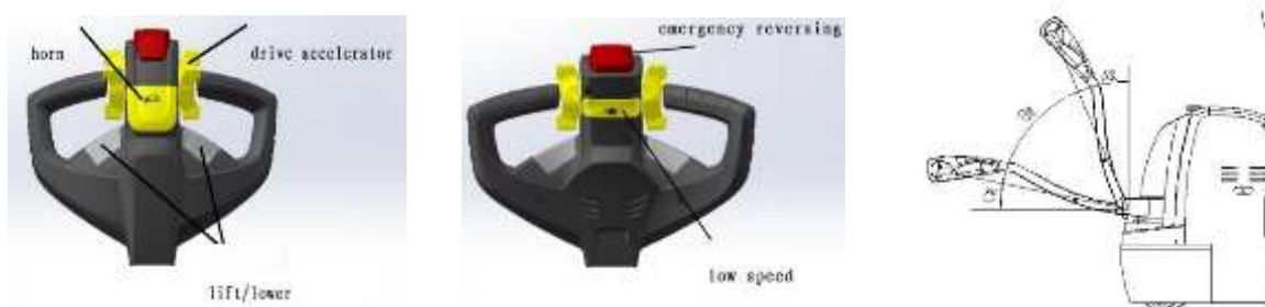
Рис.6 - Работа аварийного заднего хода штабелера
